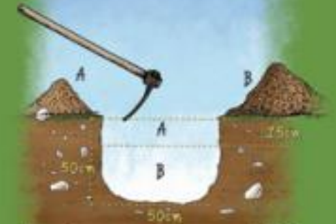
Το χώμα που εξάγεται από βάθος 15-50cm τοποθετείται στον χώρο B.
